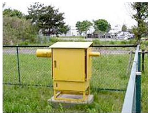
図2 高エネルギー加速器研究機構のモニタリングポストの例（左側に出ているものが中性子検出器、右側のものがγ線検出器）
