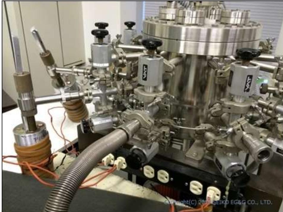
図5 メーカーによる真空引きの様子（セイコー・イージーアンドジー株）
