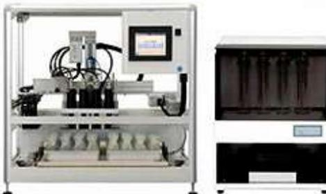
本システムは、BOD測定の希釈、測定、データ処理作業を自動化したシステムです。希釈は、サンプルを投入する事により任意の希釈倍率で倍々の8検体3段希釈24本を、約4分で行うことができ、カセットを移す事により測定装置は、順次測定を行い、パソコンでJIS丸めまで処理が可能です。
