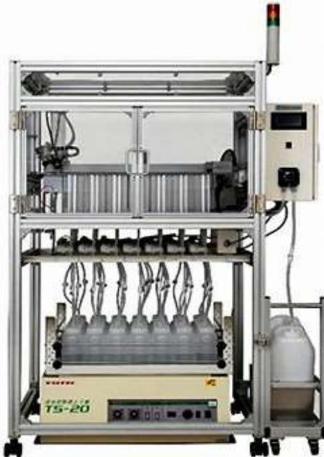
公定法の土壤溶出試験では検液作成において6時間振とうを行います。長時間の振とう時間の為、スケジュールの調整など大きな負荷となっていました。
