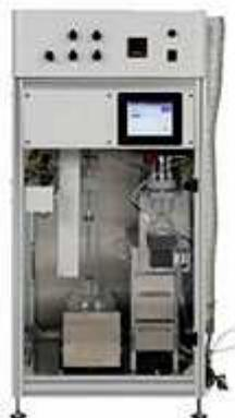
JIS K 0102 24.3抽出容器による抽出法に基づき、ヘキサン抽出を自動化した装置です。本シリーズは4、8、10検体と3機種をラインナップしており、検体数にあった機種を選択頂けます。また、環境水に対応した捕集濃縮装置も用意しております。気になるエマルジョンの濃いサンプルや、SSの多いサンプルはクロスチェックサービスをご提供します。
