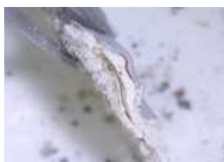
図.4 複層仕上塗材の断面写真
