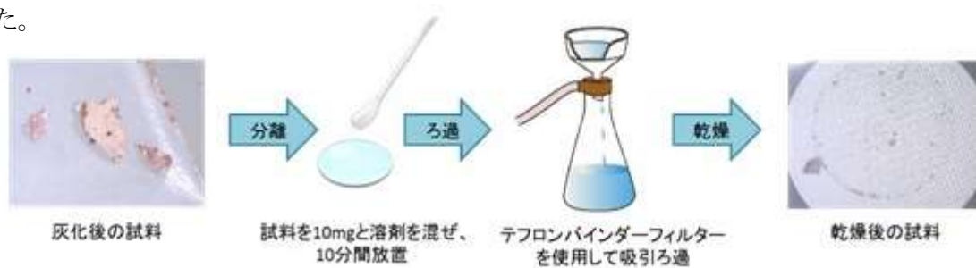
図.9 灰化試料の手順
