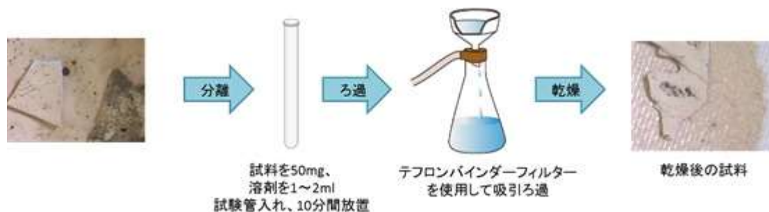
図.5 上塗剤の剥離手順
