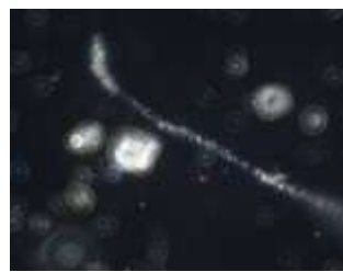
図.11 アルカリ系溶剤とアセトンで処理をしたクリソタイルの分散色
