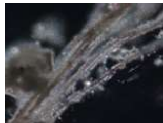
図.8 灰化、酸処理をしたクリソタイルの分散色
