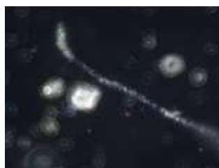
図.12 アセトン処理をしたが酸化した凝集体が付着したクリソタイルの分散色
