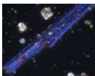
図.10 アセトン処理をしたクリソタイルの分散色
