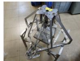
代表的なグラブ型採泥器 (スミスマッキンタイヤ型採泥器)
