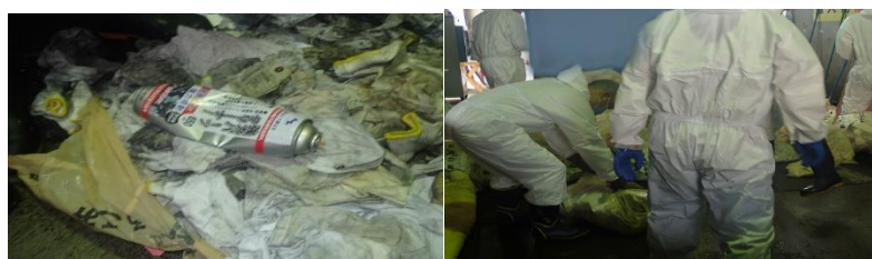
搬入物検査で確認した廃棄物（左：スプレー缶）及び展開検査の様子（右）
